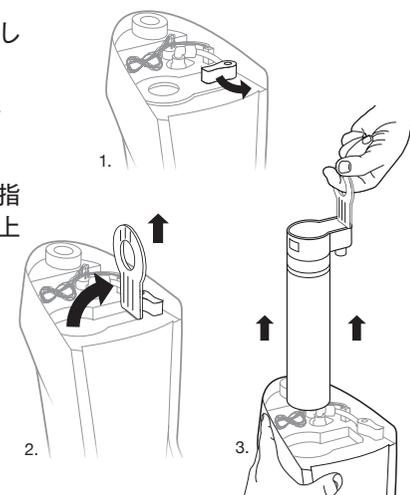
5.5 図に示すようにフィルターハウジングを反時計回りに回して、フィルターの先端部分から外してください。
