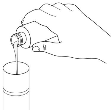
※ 洗浄液は、フィルターハウジング内側の上部ネジのすぐ下まで入れてください。およそ400mlの洗浄液が入ります。
