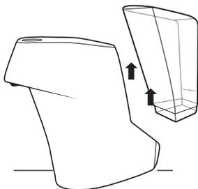
5.2 上蓋を固定している2か所のネジを回して取り外してください。この5.2のステップの作業は付属のネジ回しを使用して行ってください。
