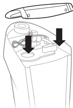
**4.11** 上蓋を固定するために付属のネジ回しを使って2カ所のネジを締めてください。
