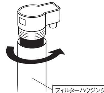
5.6 図に示すようにフィルターカートリッジをフィルターの先端部分から引き抜いて、フィルターカートリッジを取り外してください。
