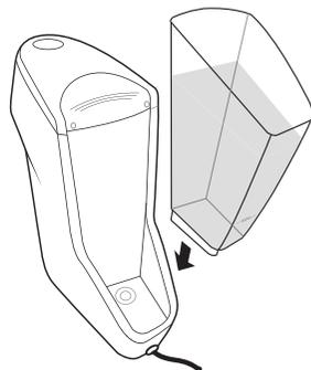
**5.13** 吐水口の下にコップか大きな容器を置いてから、吐水ボタンを押して300ミリリットルの水を注入してください。300ミリリットルの水が吐水できたら、再び吐水ボタンを押して吐水を止めてください。吐水した水は排水管に流して捨ててください。コンセントから電源プラグを外して電源を切ってください。その後、スケール洗浄液が本製品内に浸透するように15分間放置してください。15分たったら、電源プラグをコンセントに差し込んで電源を入れ、リザーバー2杯分の水を吐水して洗浄液を洗い流してください。
