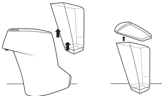
**2.4** リザーバーをよく水洗いした後で、リザーバーに水道水を入れてください。リザーバーに水道水を入れ過ぎてこぼさないように注意してください。水道水を入れたらリザーバーに蓋をします。
