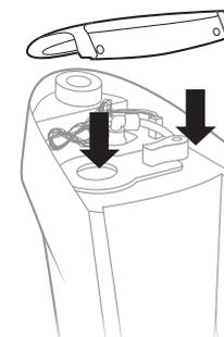
**5.11** 上蓋を固定するために付属のネジ回しを使って2カ所のネジを締めてください。
